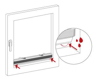
3 Befeuchten Sie die Saugnäpfe zur Verbesserung der Hafteigenschaft. Positionieren Sie das Plissee zunächst mit den unteren beiden Saugnäpfen an gewünschter Position.
